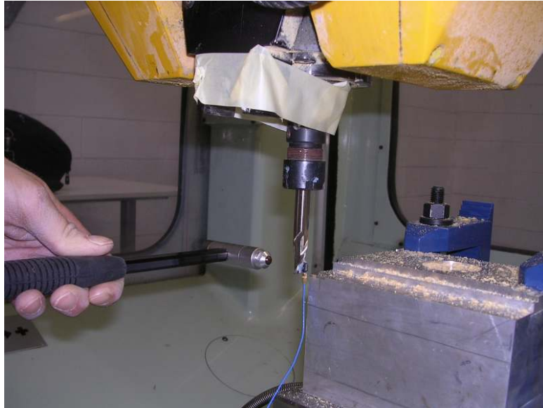
Fig. 47: Prove di caratterizzazione dinamica di una macchina a 5 assi – direzione x
