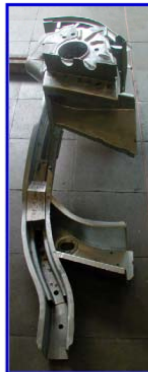
Caso Studio: Multipla Model Year 2002. Aree selezionate per il Redesign. Missioni di crash urto frontale e rigidità statica.
